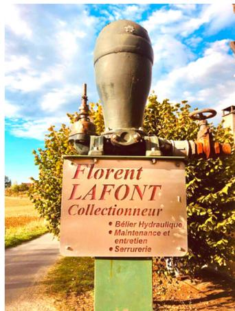
De façon générale, il faut installer le bélier entre la source et le point d'utilisation de l'eau, avec à minima 1 m de chute d'eau entre la source et le bélier pour 10 m de remontée entre le bélier et l'arrivée de l'eau.
